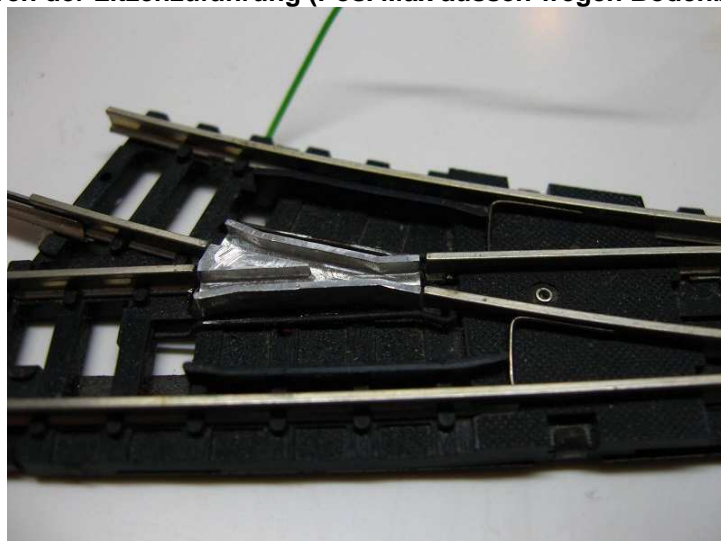
Bohren der Litzenzuführung (Pos. Max aussen wegen Bodenblech)
